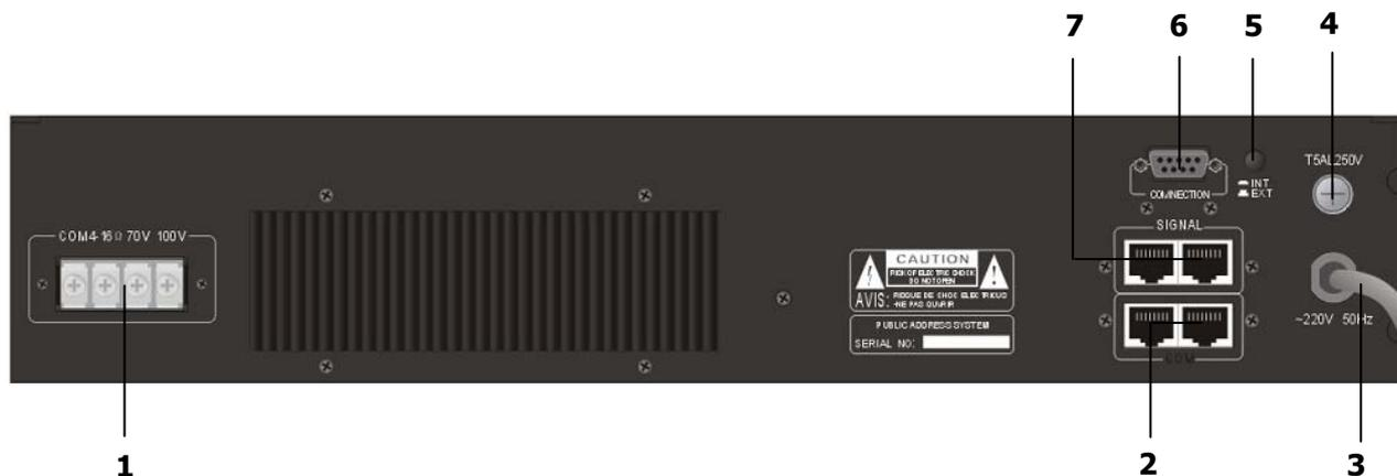
1. **ВЫХОДНЫЕ КЛЕММЫ OUTPUT** - Клеммы для подключения громкоговорителей. Предусмотрены следующие сопротивления (напряжения): 4~16 Ом, 70 В и 100 В. В любом случае используйте громкоговорители с сопротивлением равным или большим обозначенного на усилителе.
