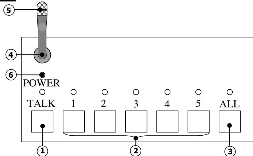
**1. Кнопка и светодиод (TALK):** Кнопка TALK предназначена для подключения звукового тракта микрофона к моноблоку. При нажатии данной кнопки происходит коммутация звукового тракта с входа AUX (ПОЗ 8 задняя панель) на микрофон. Подключение микрофона дополнительно отображается светодиодным кольцом на гусе микрофона (ПОЗ 5).
